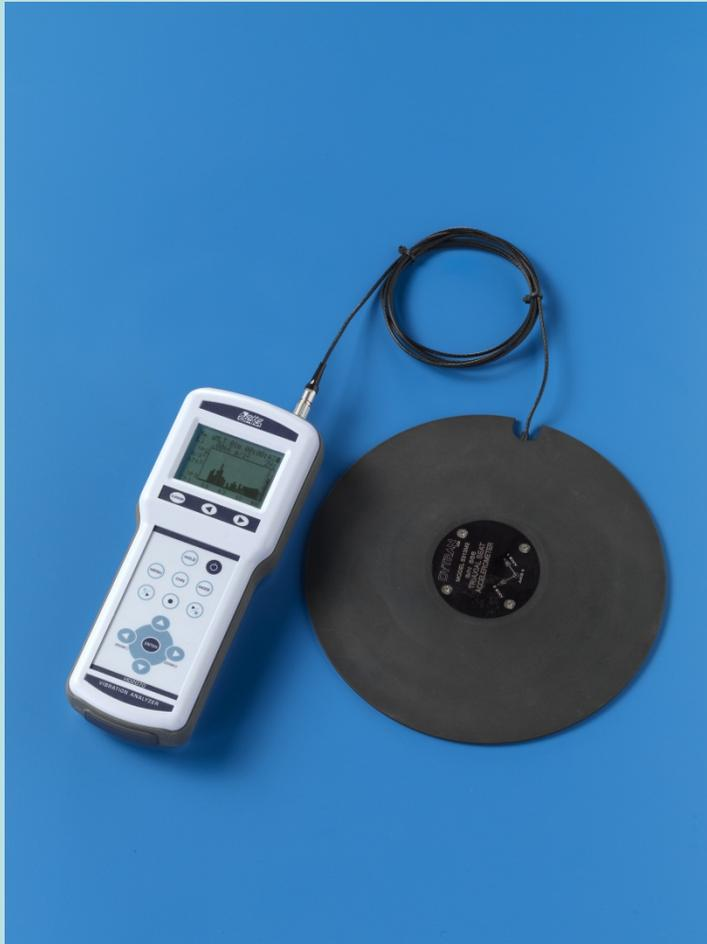
**Analizzatore di vibrazioni a 3 canali per la misura delle vibrazioni trasmesse all'uomo, conforme alla norma ISO 8041:2005.**
